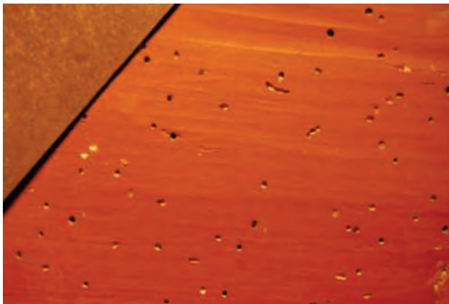
Fig. 23. Morolofii diferite ale orificiilor de zbor și ale galeriilor insectelor xilofage.
