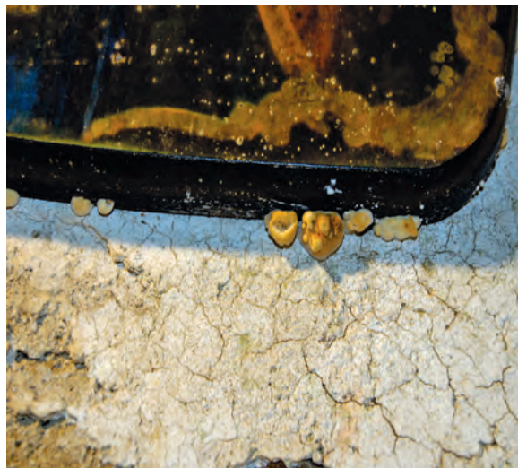
Fig. 18. Colonii de Coniophora puteana dezvoltate pe latura inferioară icoanei Maica Domnului cu Pruncul.
